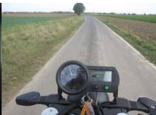
Nur die Anzeige signalisiert, dass der Elektromotor läuft. Das Display liefert Informationen über den Ladezustand.
