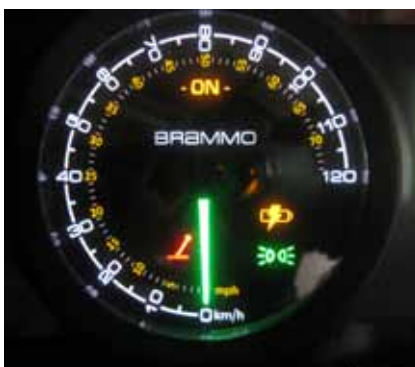
Nur die Anzeige signalisiert, dass der Elektromotor läuft. Das Display liefert Informationen über den Ladezustand.
