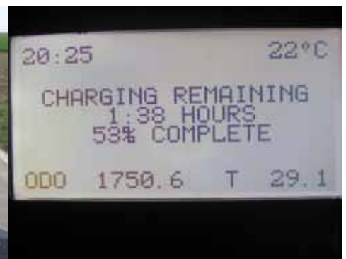
Nur die Anzeige signalisiert, dass der Elektromotor läuft. Das Display liefert Informationen über den Ladezustand.
